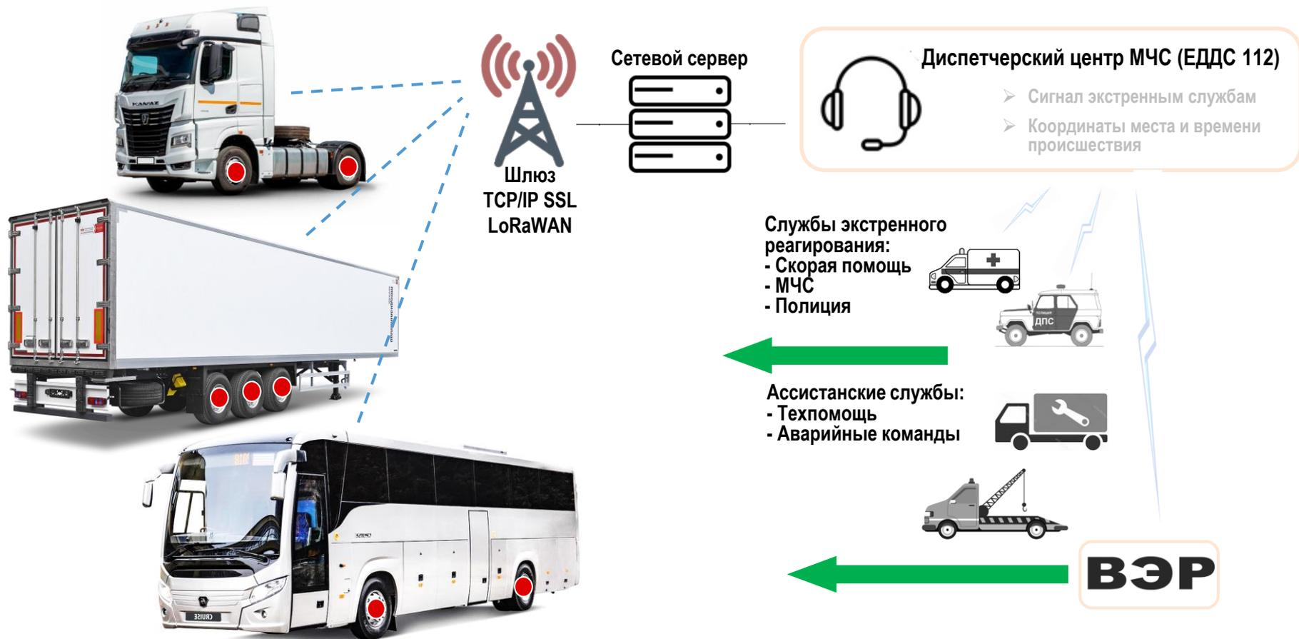
Транспорт, оборудованный STS-HUB (системой диагностики ступиц)
