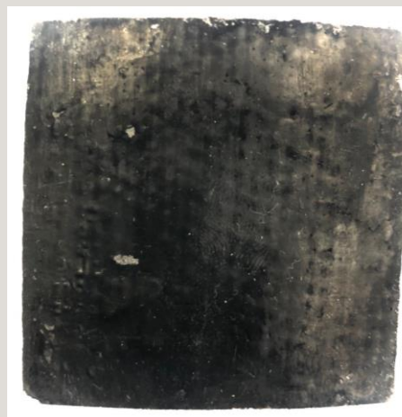
Рисунок 2 Фото микропористого слоя, нанесенного на газодиффузионный слой в виде бумаги (УНТ 10%, ТУ 90%)
