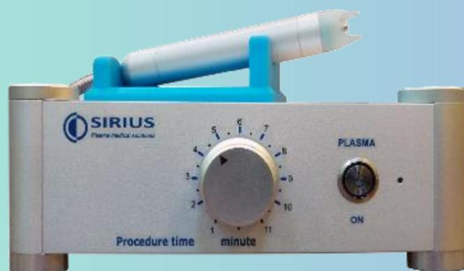
**SIRIUS** – аппарат для обработки живых тканей потоком холодной плазмы.
