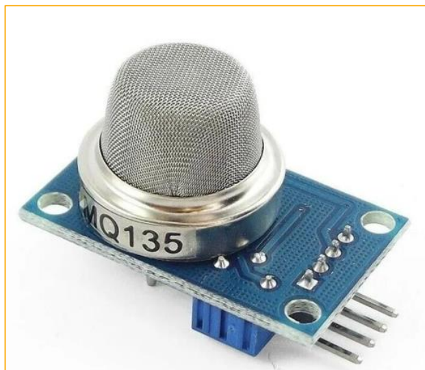
Датчик газа, реагирующий на изменение химического состава в воздухе
