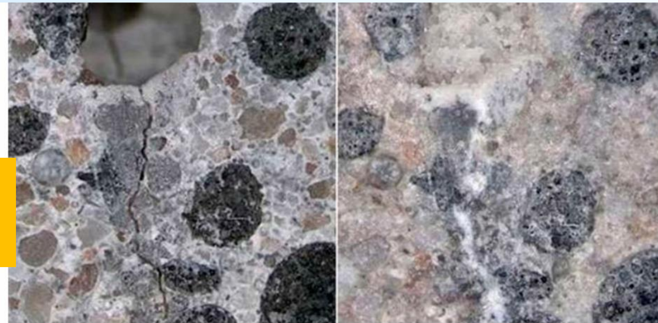
Самовосстанавливающийся бетон со спорами бактерий (Делфт)
