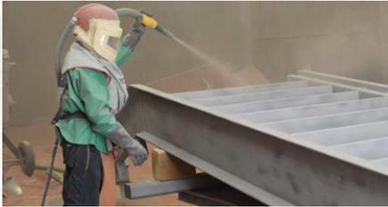
Как основные методы подготовки поверхностей к последующему нанесению защитных покрытий сегодня применяются пескоструйная и дробеструйная обработка защищаемых поверхностей. Данные виды подготовки поверхностей очень трудоемки, повреждают обрабатываемую поверхность, имеют высокую стоимость в расчете на 1 кв. метр и требуют выполнения сложных и дорогостоящих мероприятий по охране труда и защите окружающей среды. ПреоКорр же лишен всех указанных недостатков.
